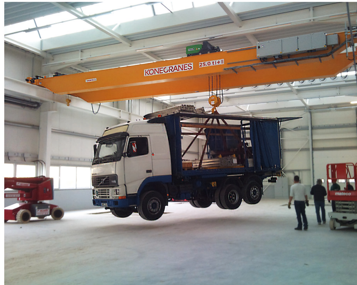
Gelungener Schnappschuss: Kranprüfung durch die IBS IndustrieBau Service GmbH
